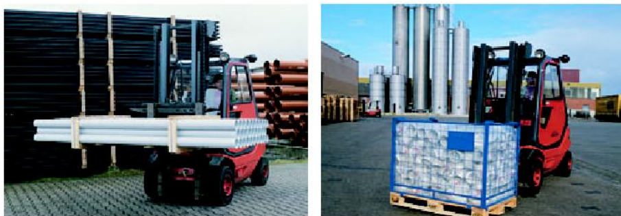
Рис. 33: Упаковка труб и фасонных деталей Wavin AS обеспечивающая сохранность при транспортировке
