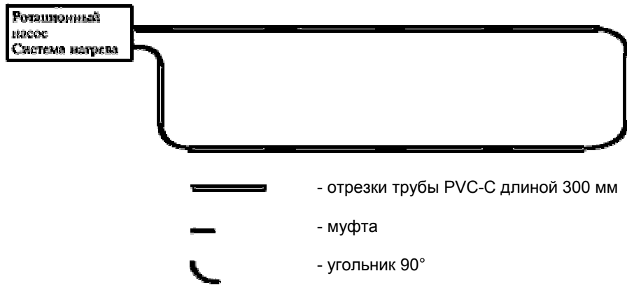
Рисунок 2 - Схема испытаний клеевых соединений труб и фитингов из PVC-C на стойкость к аварийной температуре T_{авар}
