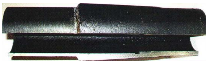
Рис. 5. 10 Сварное нахлестное соединение труб типа «НЗ»
