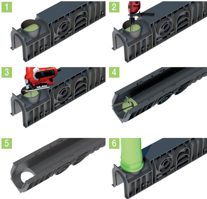
При подготовке отверстия для подключения трубы к водоотводному лотку необходимо осуществить следующие операции:
