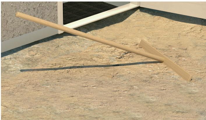
1. В случае установки поддона без подключения к системе канализации необходимо произвести выравнивание грунтового основания.
