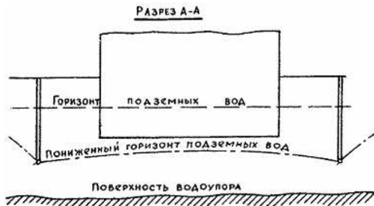
Рис.7. Схема систематического дренажа
