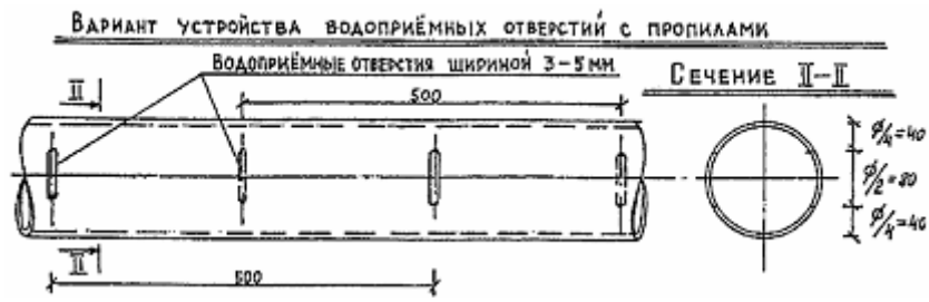
Рис.12. Труба поливинилхлоридная с водоприёмными отверстиями и с заделкой стыков
